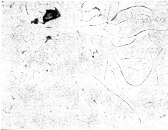
Ryc. 8. Mikrostruktura materiału rury żeliwnej. Grafit płatkowy w osnowie metalowej. Zgląd metalograficzny nie trawiony. Powiększenie mikroskopowe 100 ×
