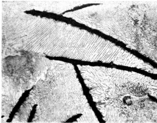
Ryc. 9. Mikrostruktura materiału rury żeliwnej. Osnowa metalowa perlityczna (składnik pasemkowy), ślady ferrytu (niewielkie białe pola) eutektyka fosforowa (jasne, kropkowane wydzielenie w prawym dolnym narożniku), grafit (czarne długie pasemka). Zgląd metalograficzny trawiony kwasem azotowym. Powiększenie mikroskopowe 500 ×
